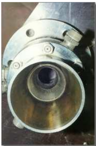
Сопло с узлом завесного охлаждения сверхзвуковой части
