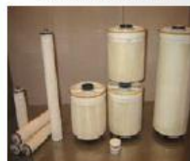
Рис. 5. Фильтрующие элементы на основе микрофльтрационной трековой мембраны
